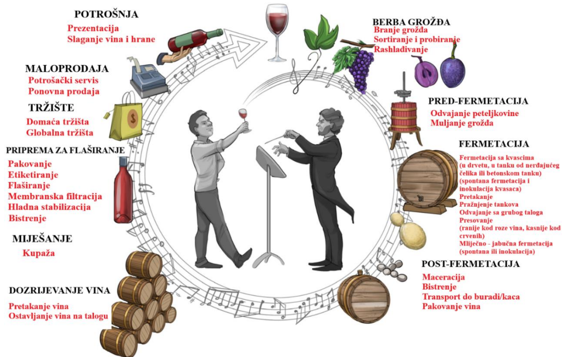
Slika 7. Glavni koraci u proizvodnji crnog i bijelog vina [13]. Neki koraci i njihov redoslijed razlikuju se između proizvodnje crnog i bijelog vina.
