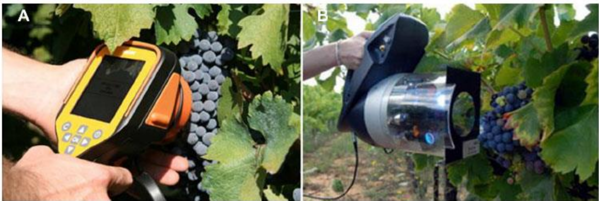
Slika 7. Senzori ručnih uređaja Spectron (A) i Multiplex (B) za proksimalnu (blisku, neposrednu) kontrolu kvaliteta grožđa, koji omogućava realizaciju mapa kvaliteta.
