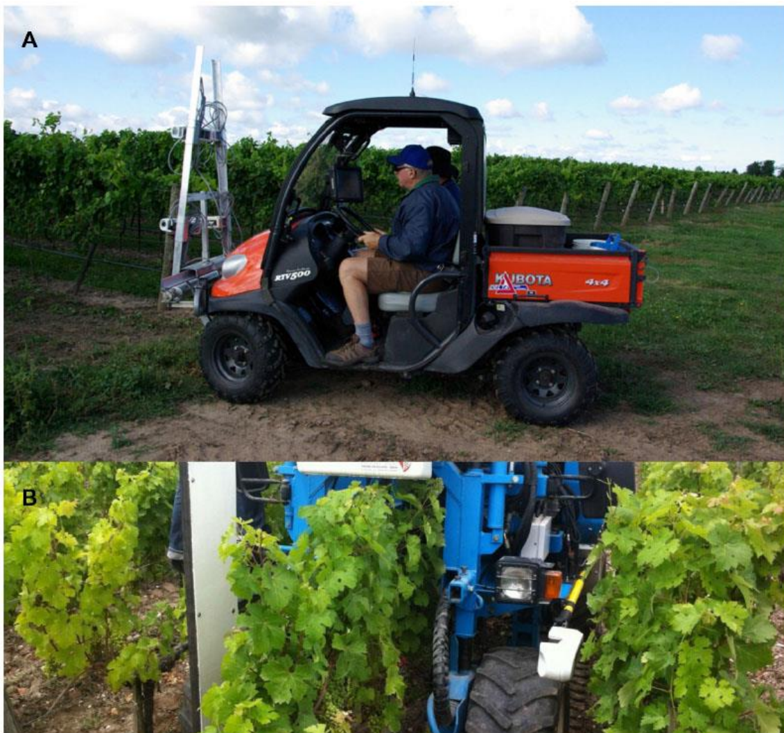
Slika 5. Trimble® GreenSeeker® multispektralni senzor za nadgledanje čokota, nošen na četverotočkašu (Practical Precision Inc., Tavistock, Kanada) (A) ili traktoru (Avidorhightech SA, Le Mont-Pèlerin, Švajcarska) (B).
